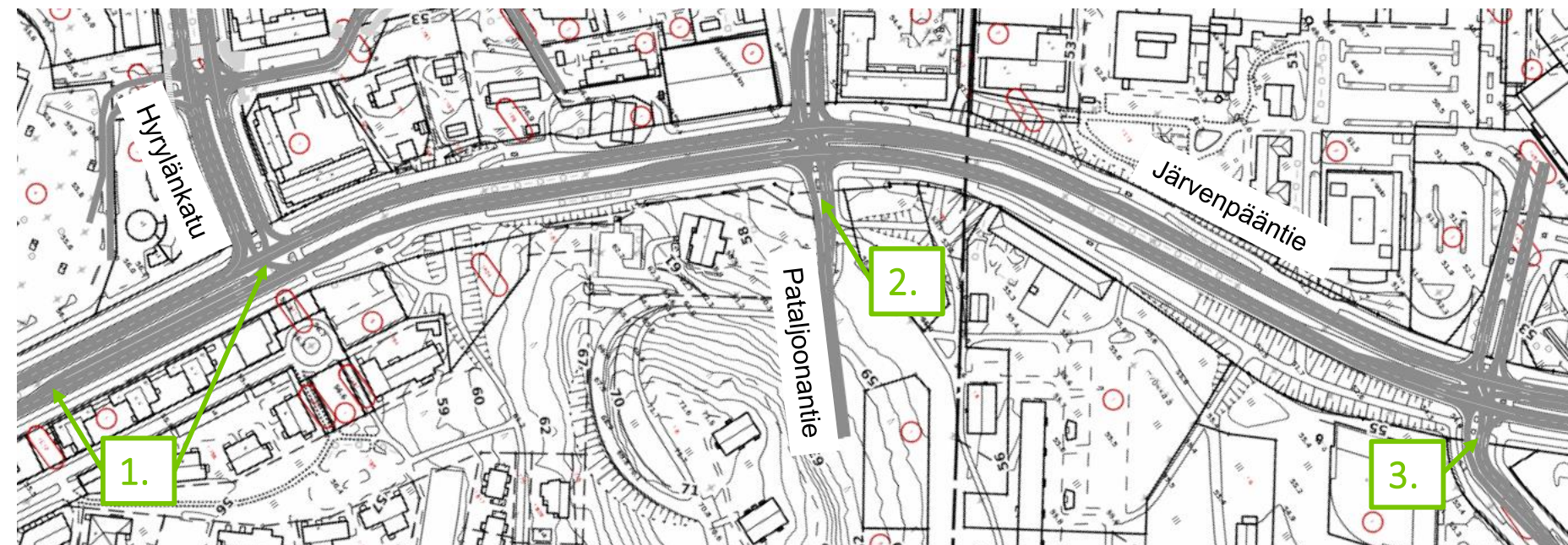
Kuva: Ennustetilanteen simulointeihin liikenneverkolle tehdyt muutokset valoliittymissä.
